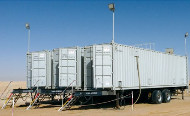
野外施工项目营地污水处理设备
